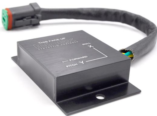
El inclinómetro mide las fuerzas de aceleración en el vehículo en 3 ejes (x,y,z), así como la velocidad de cambio de la posición angular del vehículo en 3 ejes utilizando un sensor MEMS incorporado.
